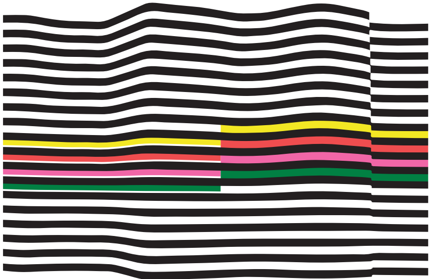
La líneas de color de la mitad izquierda no tienen reventado. Las de la derecha sí (menos fallos de registro)
